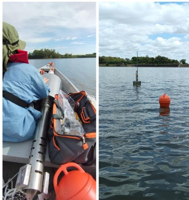
Figura 8. Boya de monitoreo del Embalse del Arroyo Canelón Grande. De izquierda a derecha: tareas de instalación, despliegue y mantenimiento del equipamiento.
