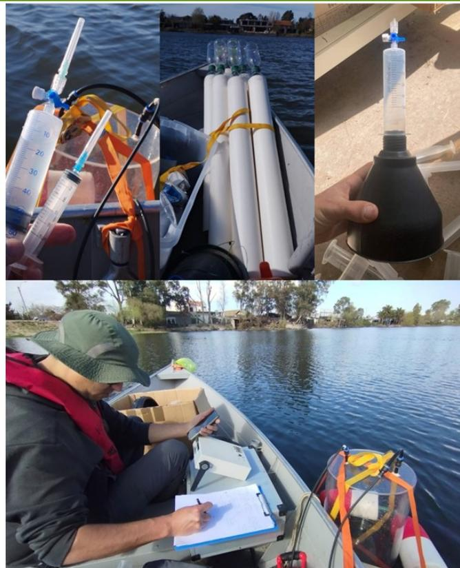
**Figura 31.** Toma de muestras para evaluación del ciclo del carbono y emisiones de gases de efecto invernadero (GEI) durante 2024 y 2025. Izquierda: toma de muestras para análisis de GEI disueltos. Medio: trampas de sedimentación. Derecha: trampas de burbujas/ebullición de GEI. Abajo: medición de intercambio superficial de CO<sub>2</sub> realizada con un analizador de gases infrarrojo (EGM-4, PPSystems).
